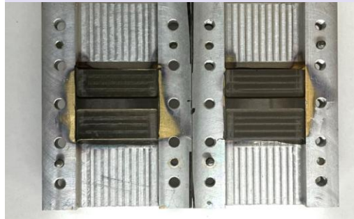
TE: 4 \mu\text{m} Au TF + Au NCs + Ag 70 Au 30 NPs
